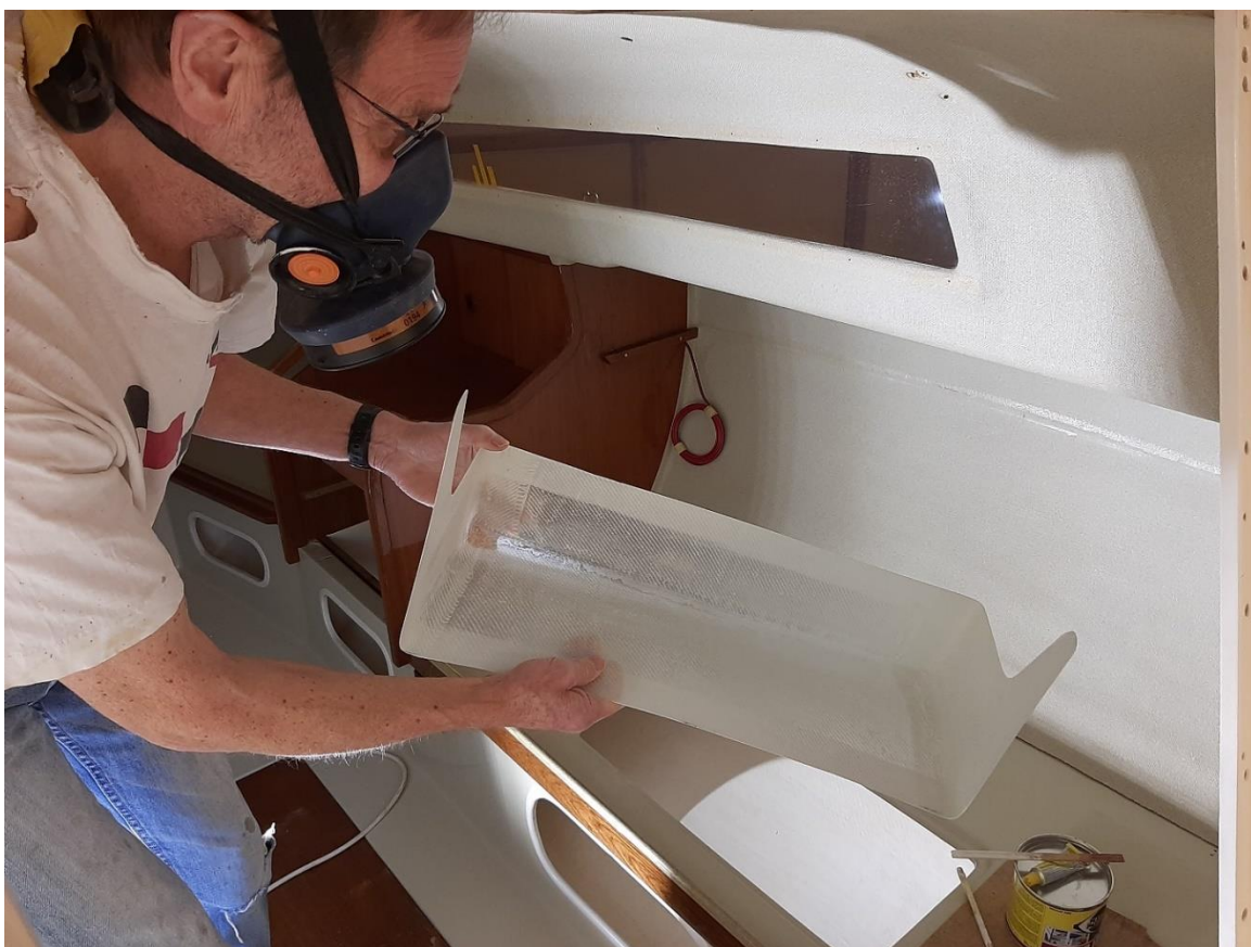
Nyttillverkat sittbrunnsfack på väg att plastas fast.
