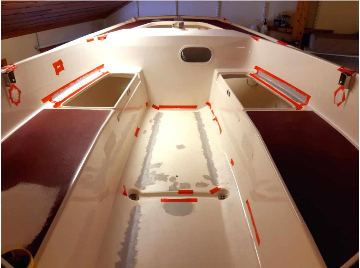
Diverse lagningar och förstärkningar
