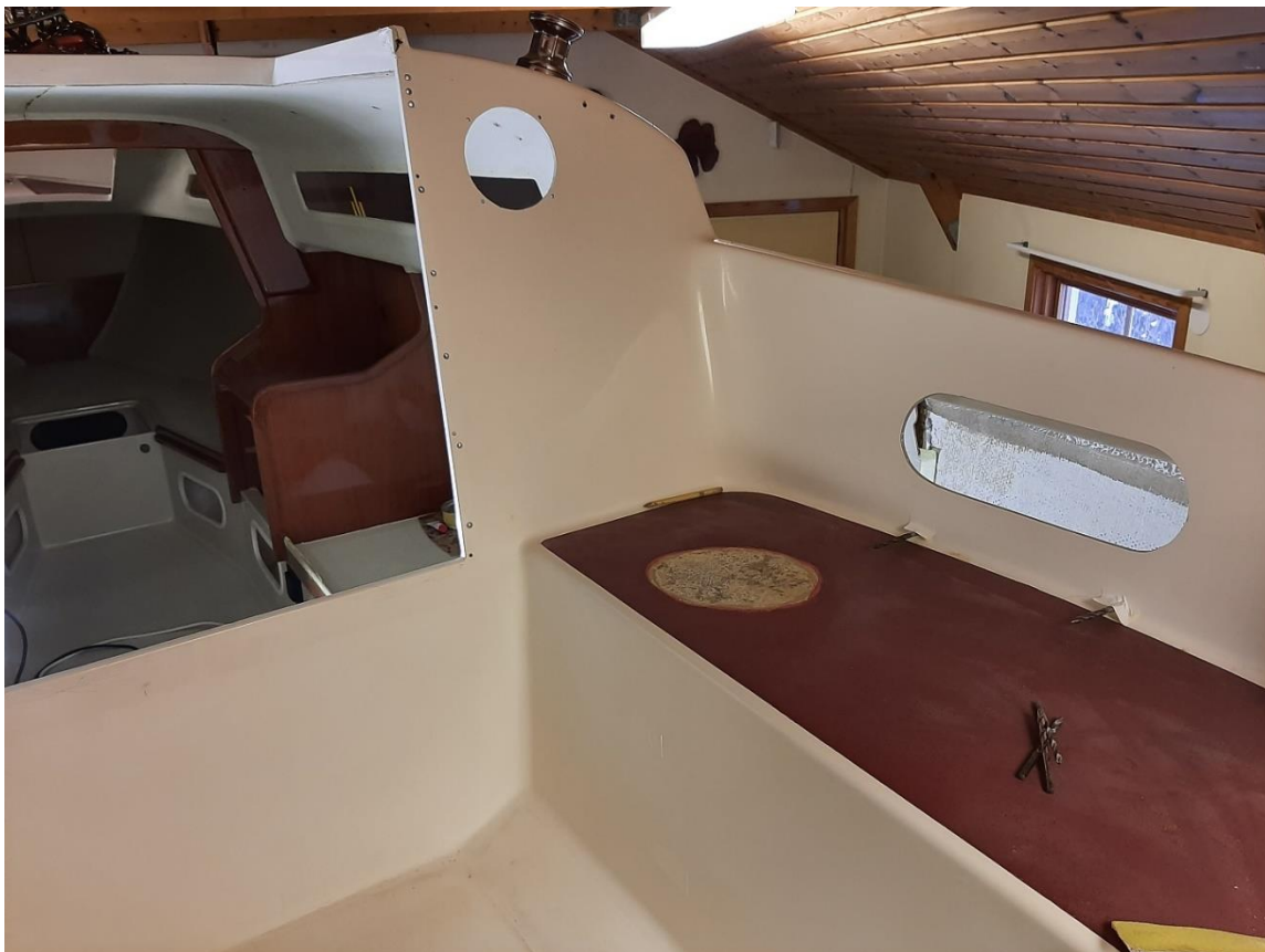
Laminatskada på toften behövde plastas, spacklas och försees med nytt rollat halkmönster före målning.
